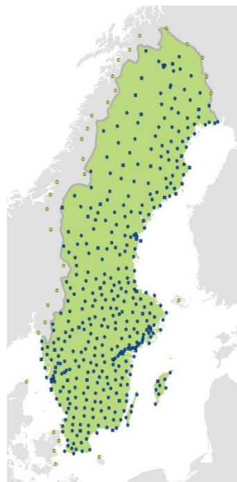
Figur 2 SWEPOS består idag av cirka 380 fasta referensstationer utspridda över hela Sverige. I SWEPOS Nätverks-RTK-tjänst ingår dessutom cirka 40 referensstationer som ligger i grannländerna och runt 20 från externa leverantörer. Källa: SWEPOS Lantmäteriet.
