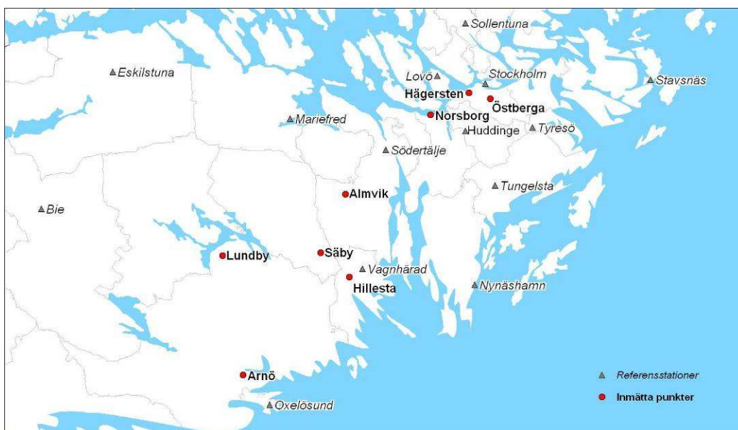
Figur 3: Bild över Södermanland som visar de punkter som valdes ut och mättes in (röda punkter) och referensstationerna (trianglar) i området.
