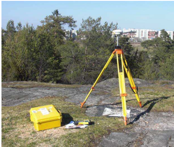
Figur 4: En typisk uppställning över en av de kända punkterna (i detta fall Östberga).
