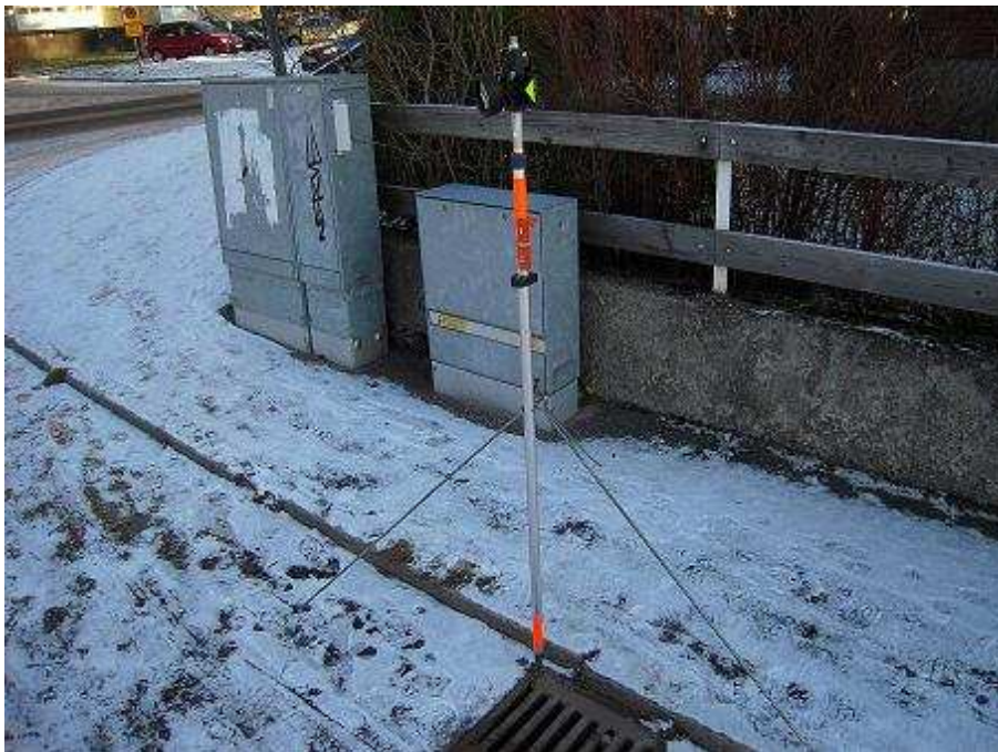
Figur 3.4: I en separat studie bestämdes ett nytt RMS med minimerat centreringsmedelfel för kontrollmetoden "nätverks-RTK - totalstation, avvikelse i horisontellt avstånd".
