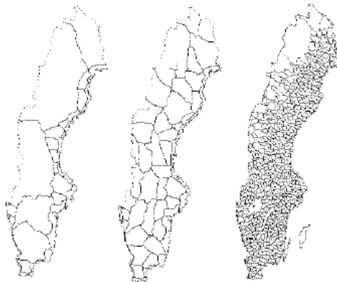
Figur 1.6. Första, andra och tredje precisionsavvägningen
