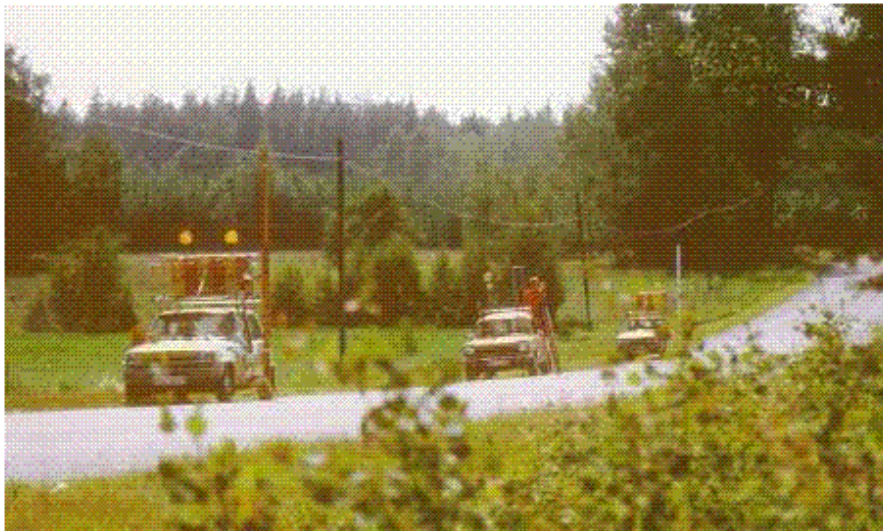
Figur 1.2. Motoriserad avvägning, uppställning med en instrumentbil i mitten, och två stångbilar.
